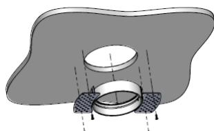
Mise en place du pot d'encastrement par le dessous et vissage dans le support
