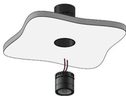
Insertion du spot dans le tube par le dessous
