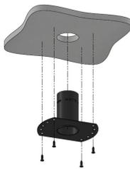
Mise en place du tube d'encastrement par le dessous et vissage dans le support
