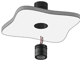
Insertion du spot dans le tube par le dessous
