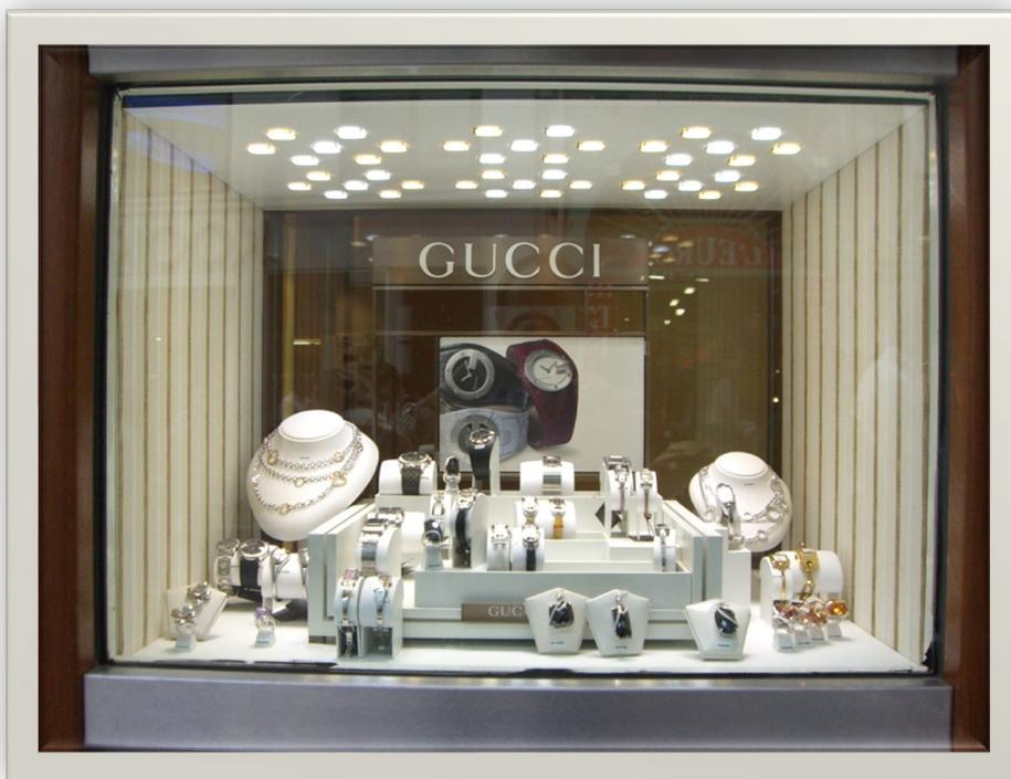
La combinaison des deux températures de couleur, en association avec la multiplication de faisceaux étroits, forme un **éclairage en 3D** et donne du relief aux objets éclairés, pour les rendre vifs et rayonnants
