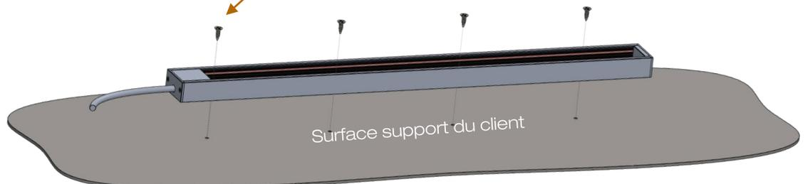
Tous les raccordements doivent impérativement être effectués avant la mise sous tension sous peine d'endommager sérieusement les LED
