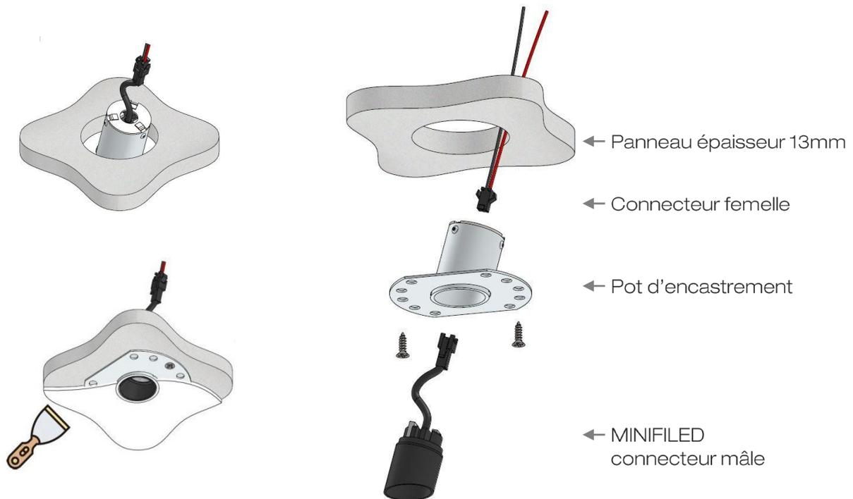
Tous les raccordements doivent impérativement être effectués avant la mise sous tension sous peine d'endommager sérieusement les LED
