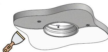
Mise en place du pot d'encastrement au dessus du support + fixation par vissage
