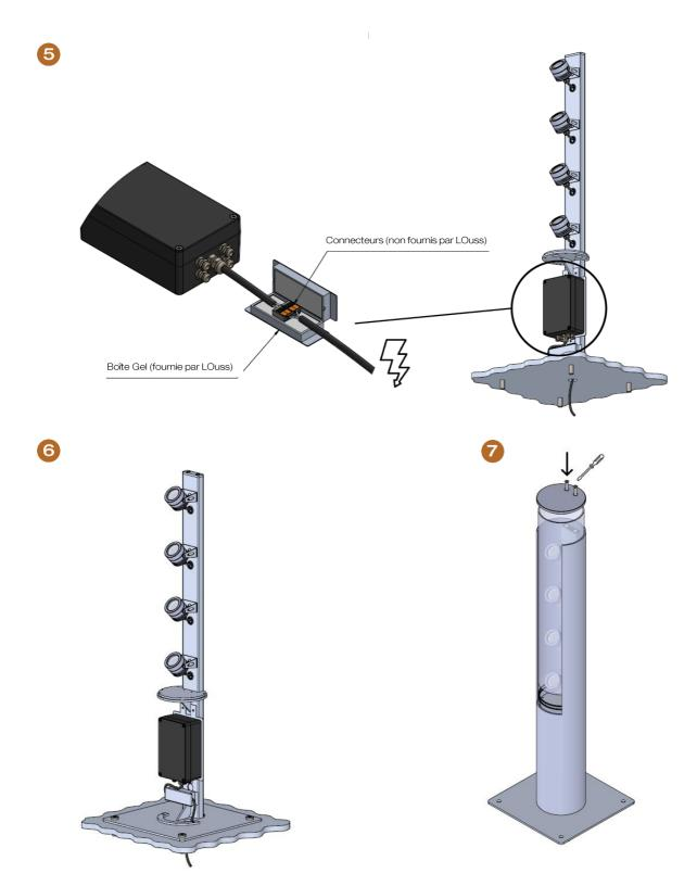
Tous les raccordements doivent impérativement être effectués avant la mise sous tension sous peine d'endommager sérieusement les LED
