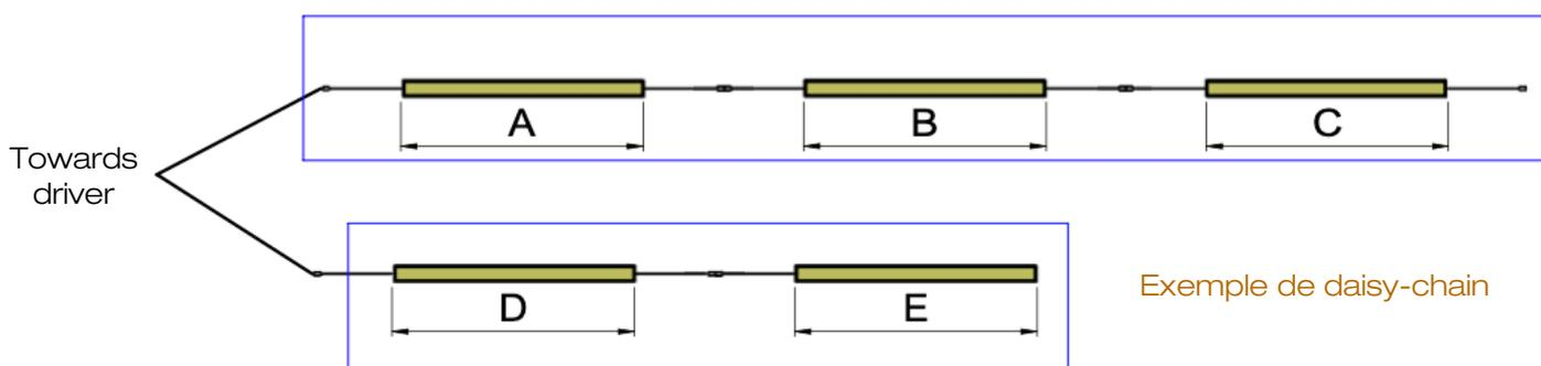
Créer autant de lignes que nécessaire pour respecter la longueur maximale par ligne, selon le ruban LED choisi et la puissance du driver
