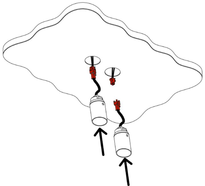
4. Insérer les spots LED et les fixer grâce aux connecteurs rapides
