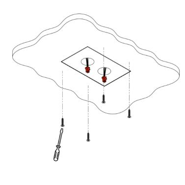
1 Insérer le câble 2 connecteurs dans le plafond 2 Insérer le bloc staff et le fixer
