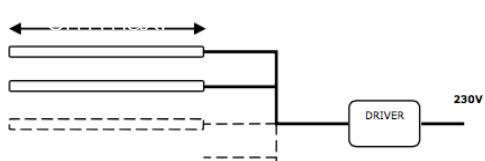
Tous les raccordements doivent impérativement être effectués avant la mise sous tension
