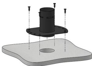
Mise en place du tube d'encastrement au dessus du support + fixation par vissage
