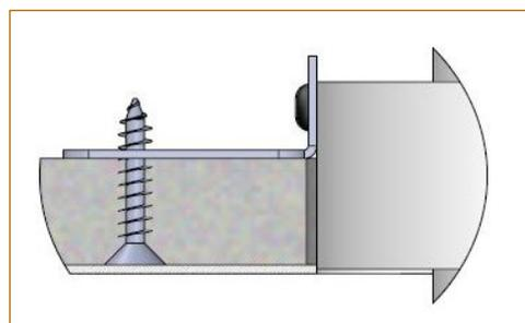
Principe d'installation par le dessous
