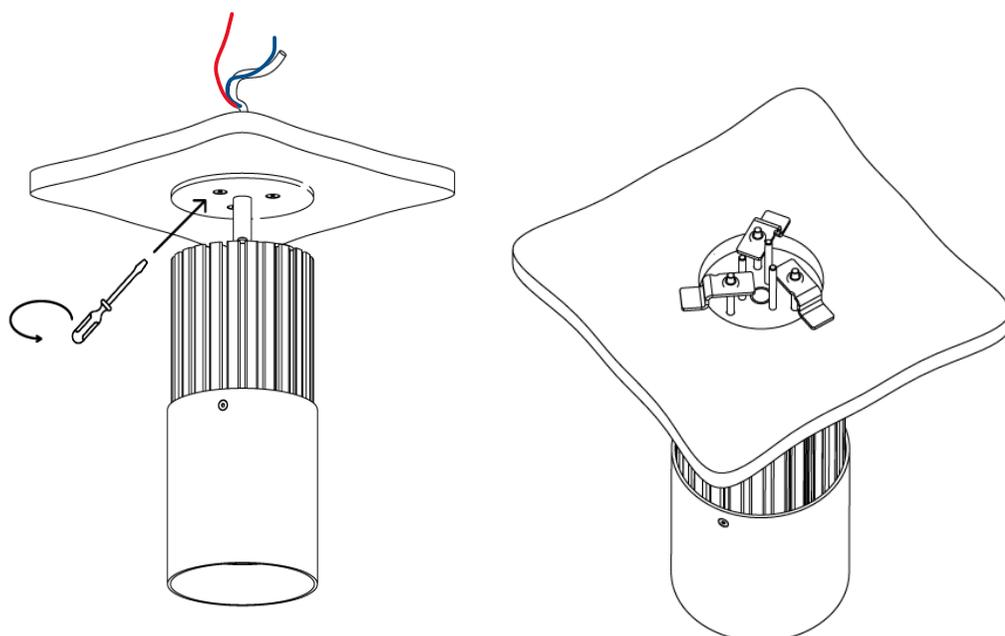
Tous les raccordements doivent impérativement être effectués avant la mise sous tension
