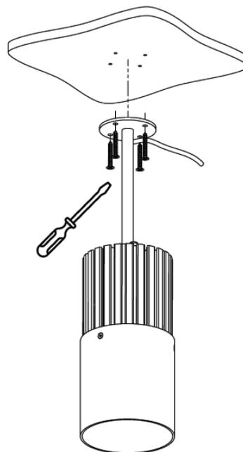
Tous les raccordements doivent impérativement être effectués avant la mise sous tension sous peine d'endommager sérieusement les LED
