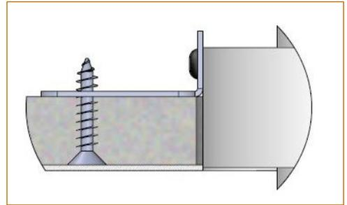
Principe d'installation par le dessous
