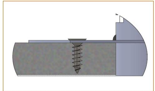
Principe d'installation par le dessous
