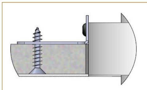
Principe d'installation par le dessous
