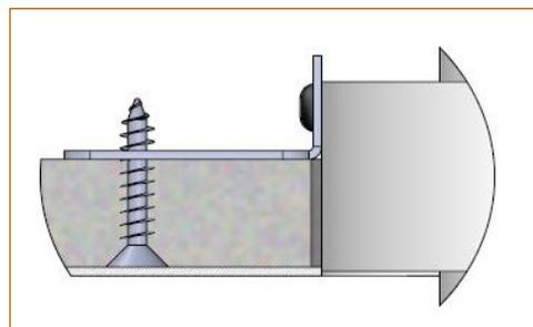
Principe d'installation par le dessous
