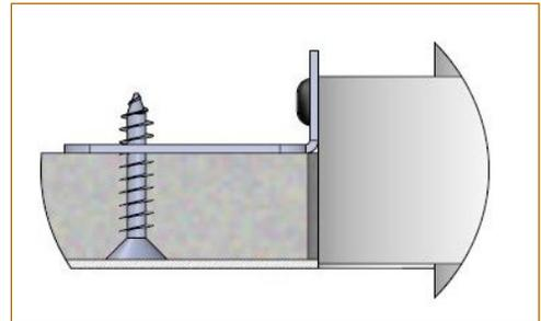
Principe d'installation par le dessous
