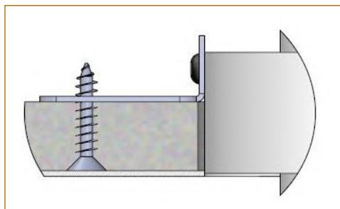
Principe d'installation par le dessous
