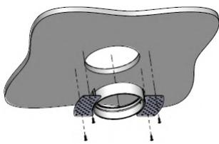
Mise en place du pot d'encastrement par le dessous et vissage dans le support
