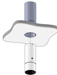
Insertion du spot dans le tube par le dessous
