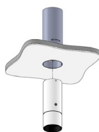
Insertion du spot dans le tube par le dessous
