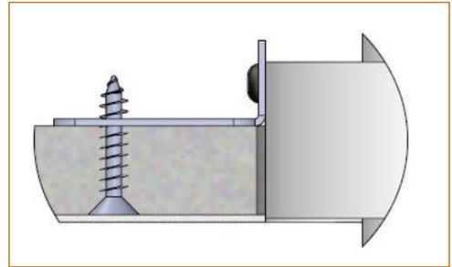
Principe d'installation par le dessous
