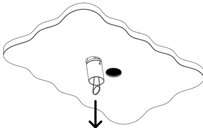
**1** Insérer l'extracteur fourni dans les 2 trous du spot à remplacer
